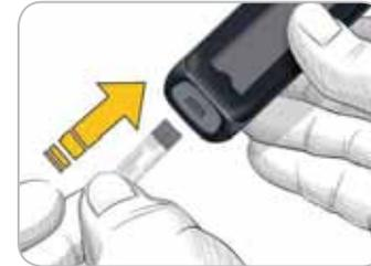
4. Stecken Sie das graue eckige Ende in die Sensoröffnung, bis das Messgerät einen Signalton abgibt.
