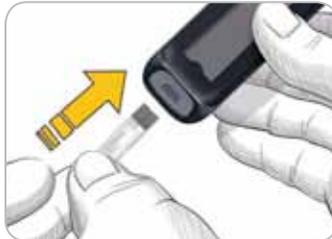
3. Halten Sie den Sensor mit dem grauen eckigen Ende zum Messgerät.
