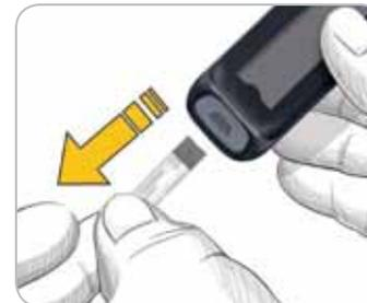
5. Um das Messgerät auszuschalten, entfernen Sie den Sensor.
