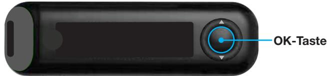
Drücken und halten Sie 2 Sekunden lang die **OK-Taste**, bis sich das Messgerät einschaltet.
